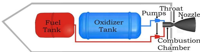
**Liquid Bi-Propellant Rocket Systems Diagram**
